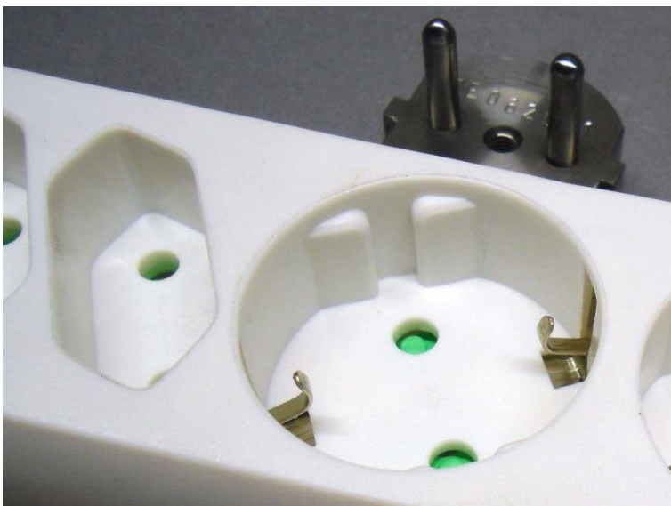
Abb. 3 Schutzkontakte der Mehrfachsteckdose sind im Anschluss an ihre Prüfung nach innen verbogen
