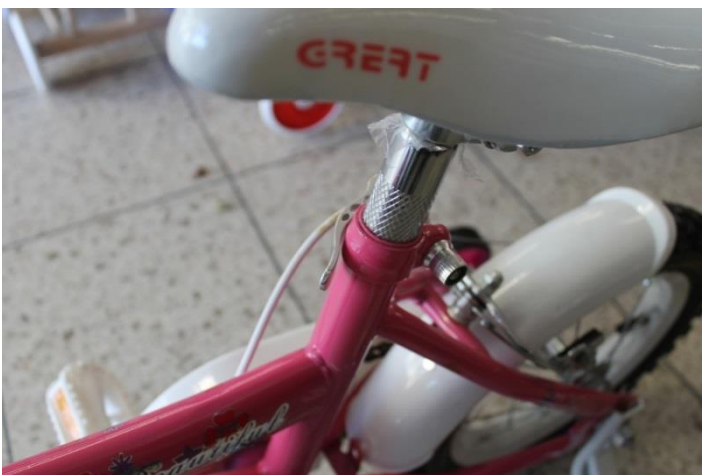
Bild 3 Selbst an der Sattelklemme eines Kinderfahrrads darf keine Schnellspannvorrichtung verbaut sein
