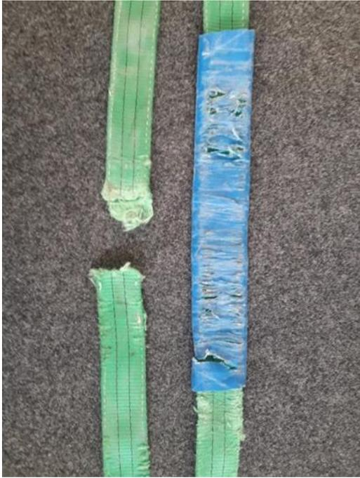
**Abbildung 20** gerissenes Hebeband (Quelle: LAV)
