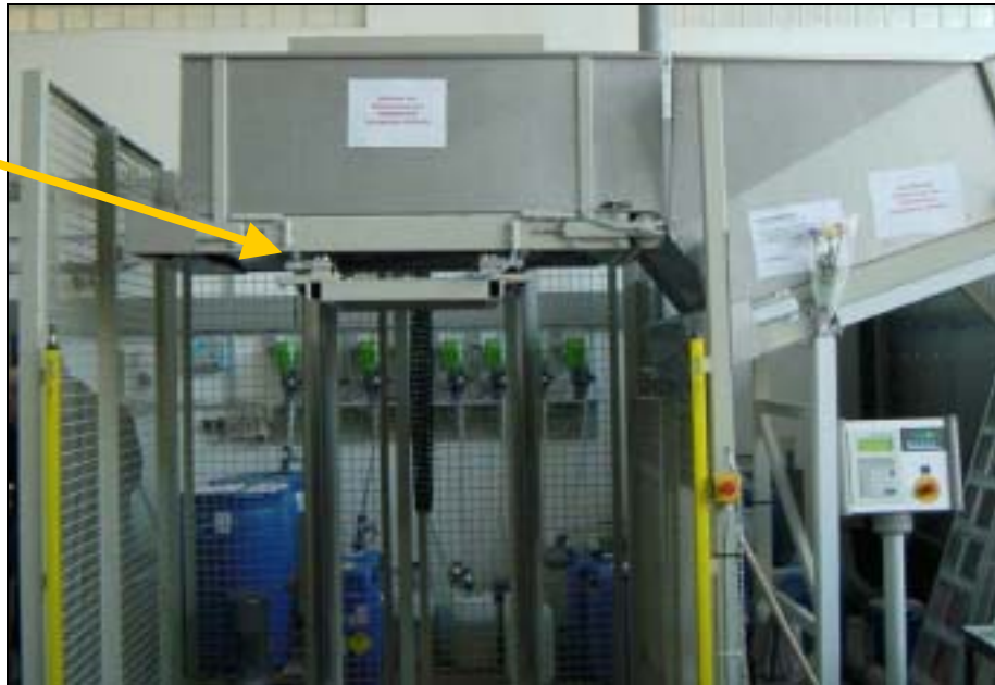
Abb. 13 Hubband der Beschickungsmaschine im angehobenen Zustand
