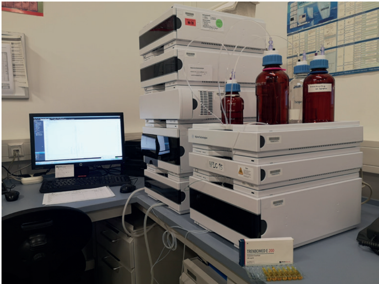
Abbildung 9 Untersuchung von Verdachtsproben mittels Hochdruckflüssigchromatographie
