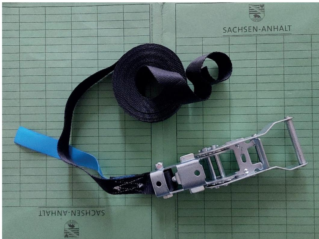
Abbildung 23 Einteiliger Zurrgurt mit Ratsche als Spannelement (Quelle LAV)
